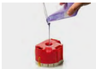
5. Pour Elite Double 16 into the flask
